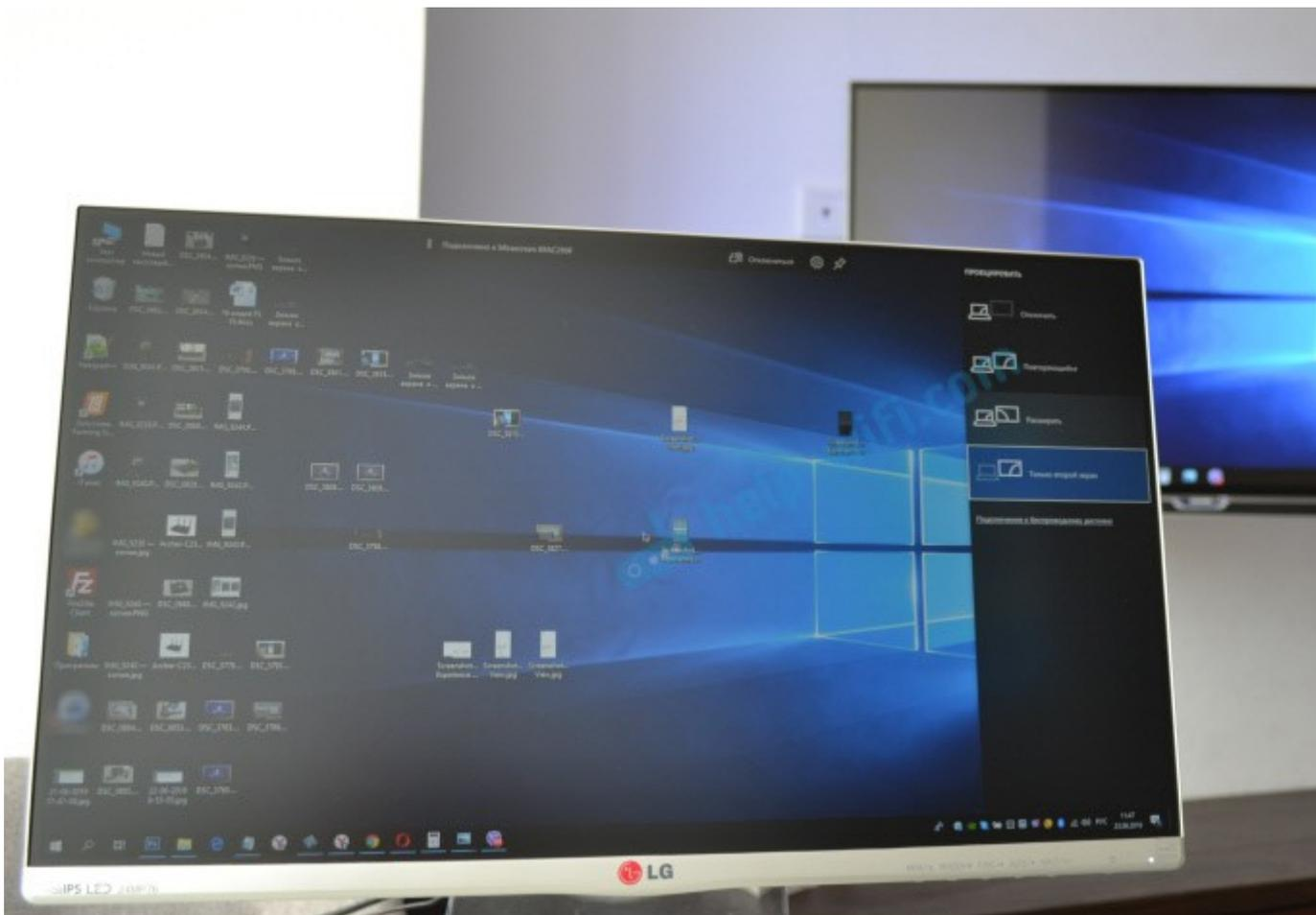
По умолчанию он подключается в режиме "Расширить". Но режим можно сменить через меню Win + P уже после подключения. На экране будет отображаться небольшая менюшка с настройками трансляции изображения на беспроводной дисплей.
