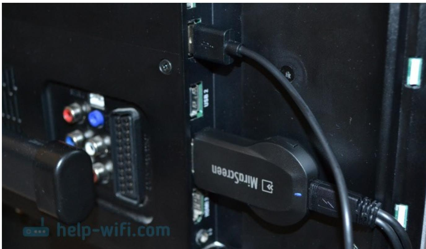
Включите телевизор (если он был выключен) . Если на экране телевизора автоматически не появится заставка адаптера, то нужно в настройках телевизора в качестве источника выбрать
