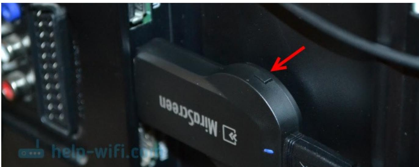
Или через панель управления (ссылка на инструкцию выше) , но кнопкой удобнее. Нажали один раз на кнопку и режим работы изменился. Выбираем нужный режим в зависимости от того, с какого устройства мы хотим транслировать изображение.
