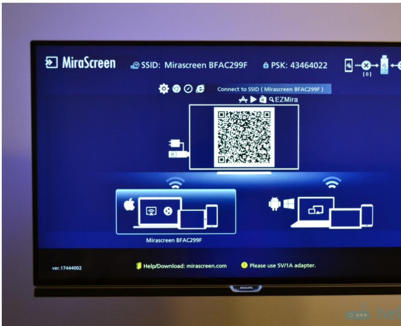
Дальше желательно настроить MiraScreen адаптер. Основная настройка - подключение к роутеру по Wi-Fi сети. Это необходимо для работы соединения по DLNA и вывода изображения на телевизор с iPhone, iPad и компьютеров на Mac OS (трансляция по AirPlay) . Вот подробная инструкция по настройке: 192.168.203.1 - настройка Miracast адаптера. Что делать, если не заходит в настройки MiraScreen и AnyCast? Windows и устройства на Android соединяются с адаптером напрямую, не через роутер.
