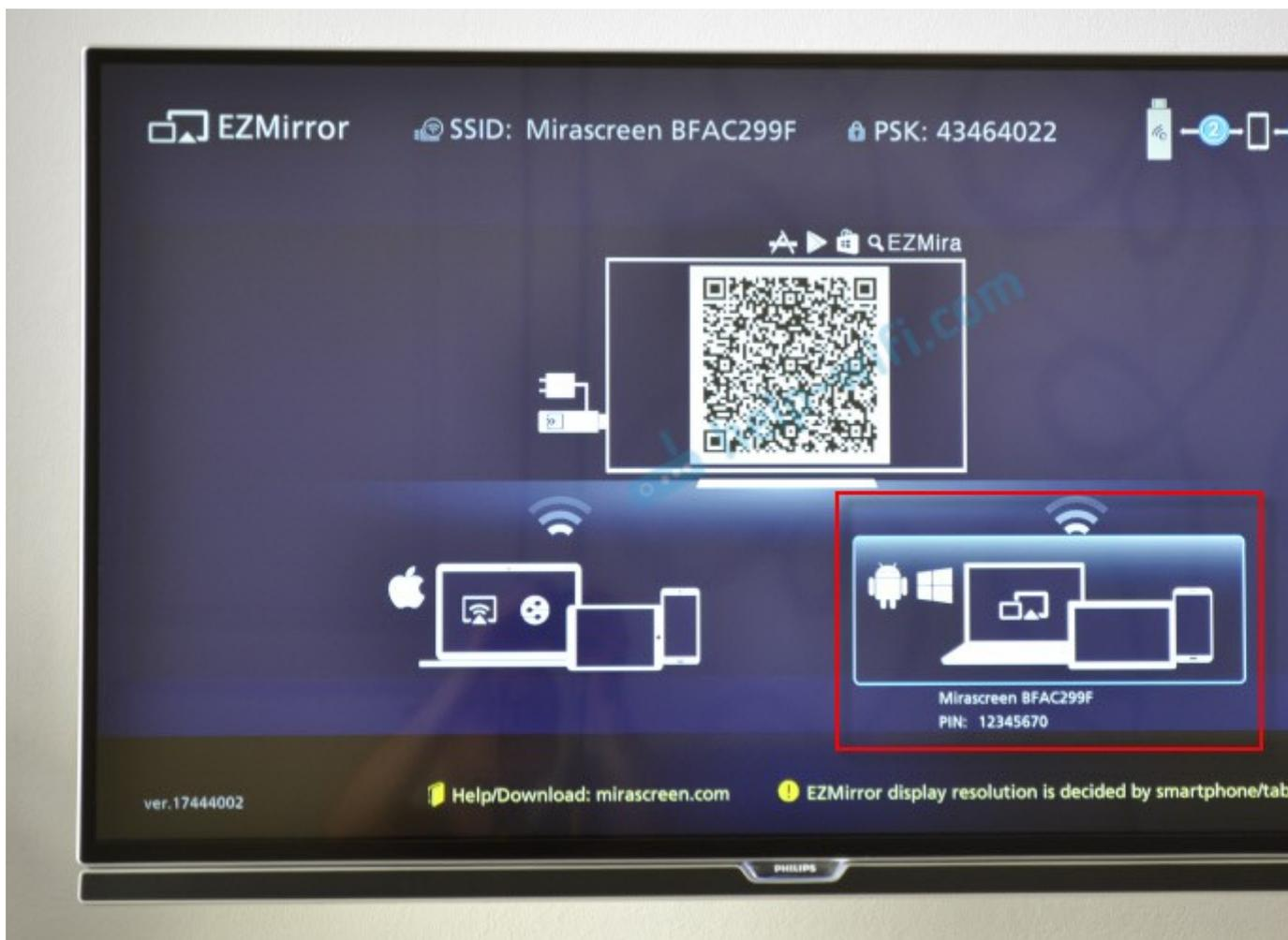
На компьютере нужно нажать сочетание клавиш Win + P, затем выбрать "Подключение к беспроводному дисплею" и в списке доступных устройств выбрать свой адаптер.
